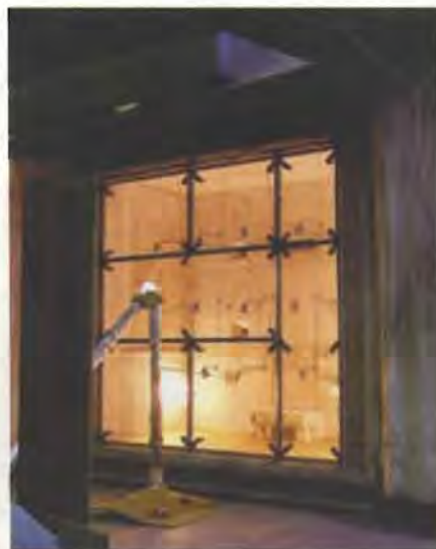
Bild 3. Nachweis der Brandwiderstandsfähigkeit von Glaswänden im Großbrandöfen der MPA Braunschweig (Bilder: Wuppermann Staba)
