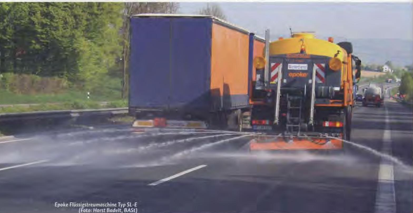
Epoke Flüssigstreumaschine Typ SL-E
