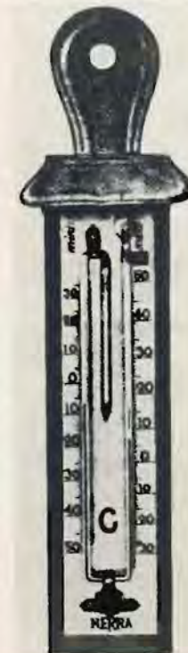
Abb. 1. Maxima-Minima Thermometer nach Six (HERRA - Grefrath)
