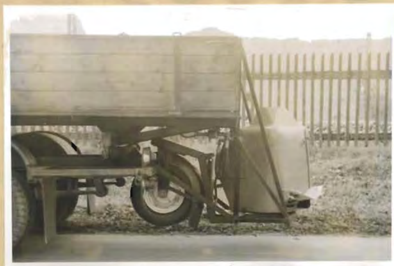
Bild 1 Gerät am hinteren Ende eines Lastkraftwagens (Schlepprad für die Dosierung gehoben)
