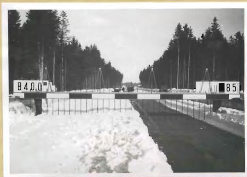
Abb. 13 Profilbalken, Messung nach Pflug- durchgang
