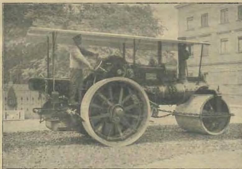
Dampfstraßenwalze der Maschinenfabrik Sölingen.
