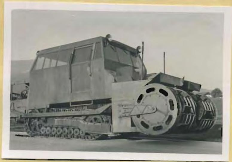
Bild 1 Grossmodell der Schallertfräse
