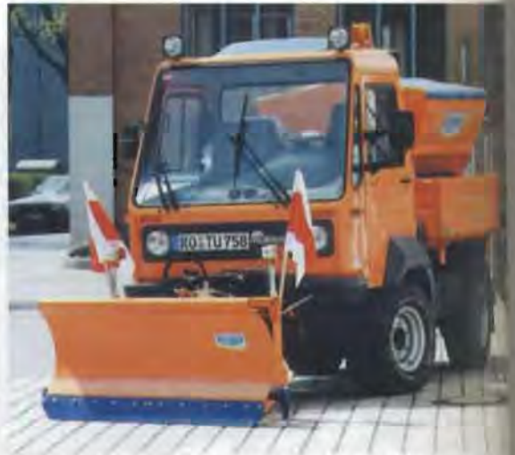
Für den Universalgeräteträger Multicar bietet Beilhack den kleinen Pflug aus der »PV 1« an.
