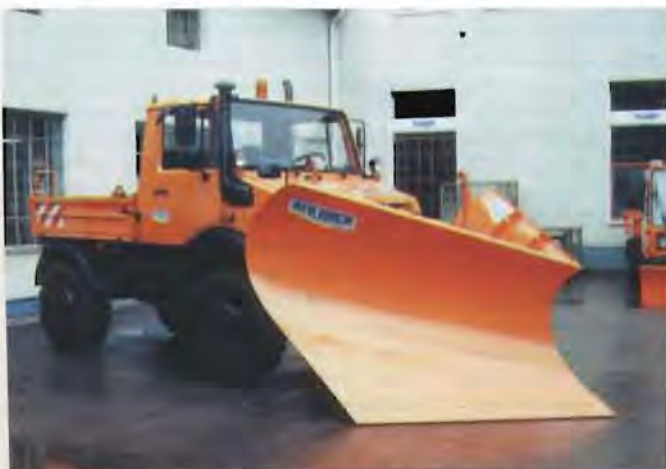
Als Programm-Ergänzung bietet die Raublinger Firma Beilhack Keilpflüge mit Räumweiten von zwei bis 2,90 Metern an. Diese Räumschilde eignen sich zum Anbau an den Unimog.
