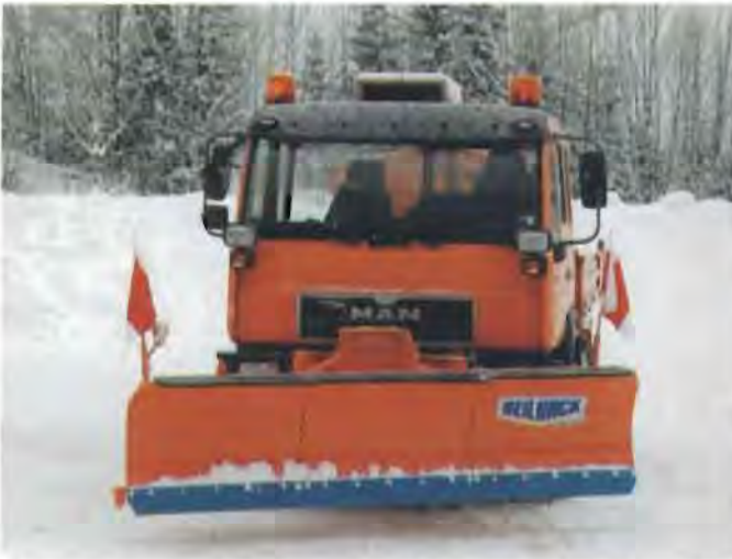
Der »City«-Schneepflug von Beilhack aus der »PVL«-Reihe ist nicht nur in der Stadt, sondern auch in schneearmeren Regionen einsetzbar.
