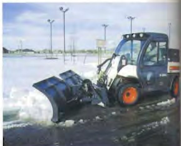
Der neue, hydraulisch verstellbare Schnee-V-Schild, hier an einem »Toolcat« fünf verschiedenen Schildstellungen eingesetzt werden.
