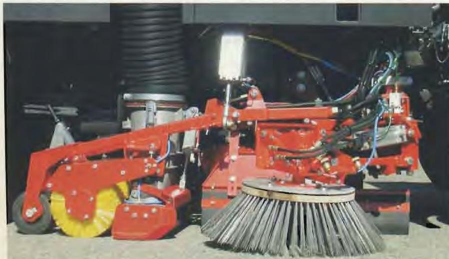
Ein Blick in das Untergeschoß der neuen Schmidt-Maschine. Der Rinnsteinstellerbesen führt dem Saugmund den Schmutz zu; direkt hinter dem Saugschacht ist eine Kehrwalze angeordnet, die eventuellen Restschmutz nachreingt.
