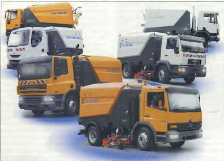
Die neue »schwere Klasse« im Kehrmaschinen-Sortiment von Schmidt: Die bis zu sieben Kubikmeter Schmutz aufnehmende »SK 650«, die inzwischen für alle gängigen Fahrgestelle (Mercedes-Benz, MAN, Scania, Daf, Renault) zu haben ist.
