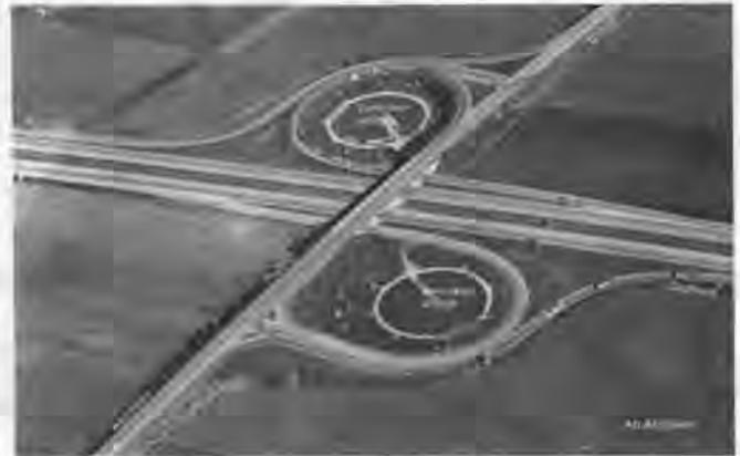
9: Anschlußstelle Aschheim, 1. Ausbaustufe eines späteren Vollkleeblatts (mit Versickerungsanlage für Oberflächen- und Grundwasser aus dem benachbarten Pumpwerk). Freigegeben Reg. v. Obb. Nr. G 30/8265, Luftbild: Prugger
