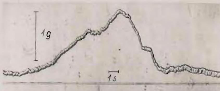
Abb.36 Beschleunigungsverlauf beim Abfangen eines Flugzeuges (Aufzeichnung des Gerätes für statistische Untersuchungen)
