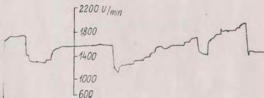
Abb.41 Ausschnitt aus einer Aufzeichnung der Motordrehzahl
