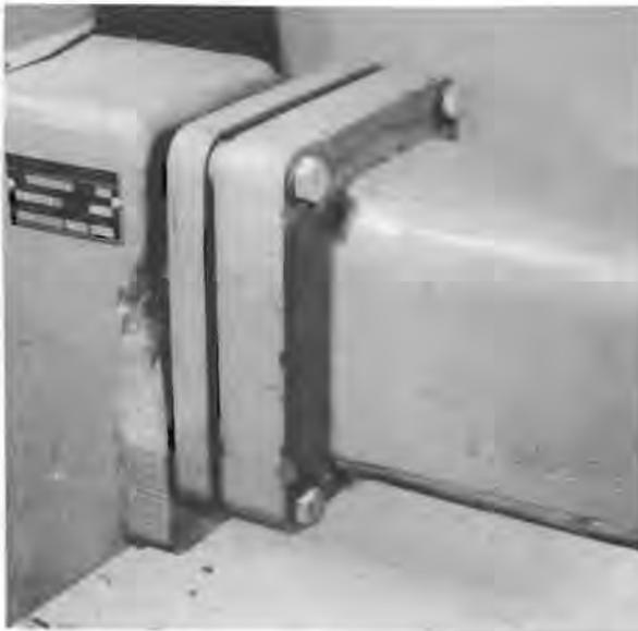
Die Fahrgestell Nr. ist am Achsträger rechts vorn hinter dem Führungsbügel eingeschlagen.
