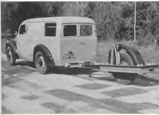
Bild 11: Bayerischer Unebenheitsmesser nach amerikanischer Konstruktion
