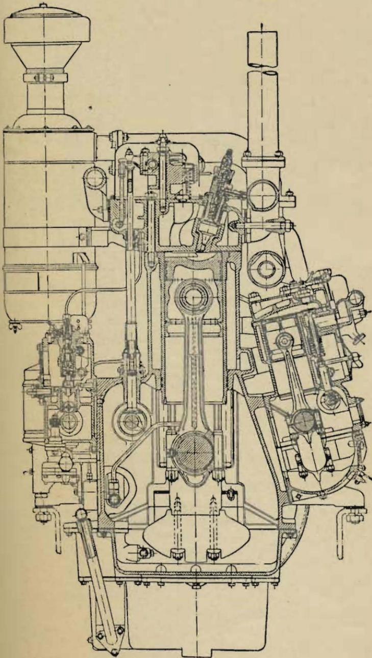
Bild 11 Querschnitt durch den Dieselmotor und Anlaßhilfsmotor, vorne
