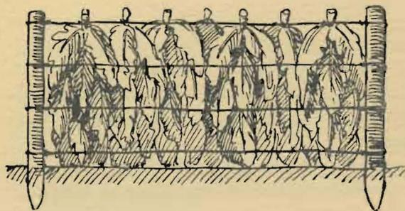
Abb. 12. Behelfsmäßiger Schneezaun mit Pfählen u. quergespannten Drähten oder Querverbindungen durch Stangen bzw. Latten und dazwischengeflochtenen Zweigen, Ästen oder Stroh. Bei Tannenwald (Fichten) „Daxen“.—
