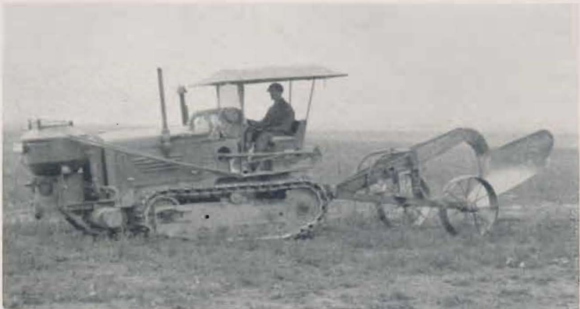
Abb. 2. Ansicht des Grabenpfluges mit Zugmittel
