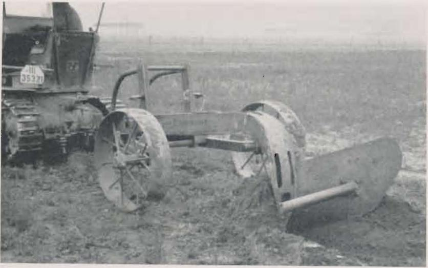
*Abb. 6. Pflug fährt an und dringt in den Boden ein*
