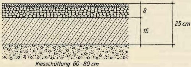
**Abb. 3 Zementbeton-Unterbau ohne Fugen**
