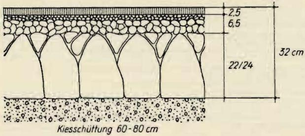
**Abb. 1 Normalausführung: Packlage mit Sand verfüllt**
