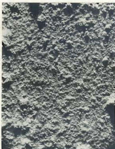
Abb. 20 Oberfläche eines rauhen Basaltes nach einem Vestolit-Abguß (Negativ), Probe I 2, Bd.-Str. 257, km 31,915.
