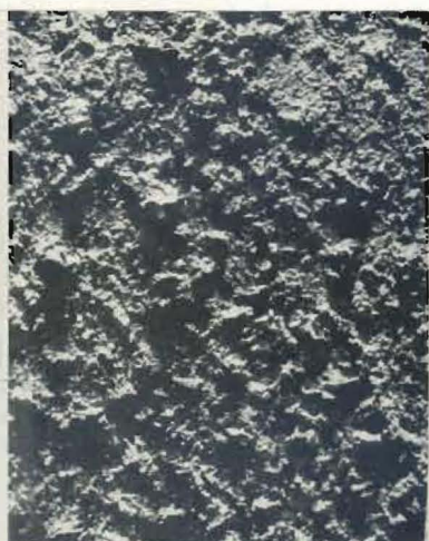
Abb. 21 Oberfläche eines Granites, nach einem Vestolit-Abguß, Probe Gr (Negativ), Bd.-Str. 9, bei Neuß-Grimlinghausen.
