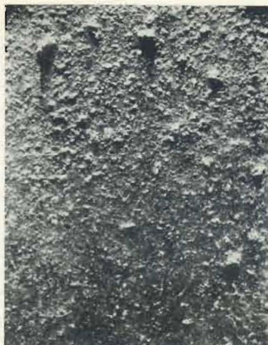
Abb. 18 Oberfläche eines glatten Basaltes nach einem Vestolit-Abguß (Negativ), Vergr. 3,9 x, streifende Beleuchtung, Probe E 25, Bd.-Str. 1. O. 376, bei Kapellen/Erft.
