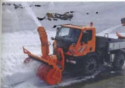
Abb. 6.5: Unimog U 20 mit Frässhleuder
