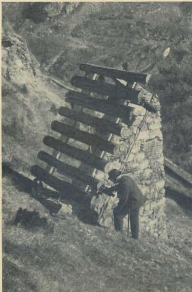
Abb. 23a. Schneedruckapparat Alp Grüm mit schwebend gelagertem Druckrost von 6 m 2 Fläche (zirka 2200 m ü. M.). (Photo H.)
