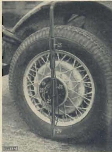
Bild 26. Fahrzeug-Versuchsrads mit Umdrehungs-Kontaktgeber. Nähere Erläuterungen im Text.
