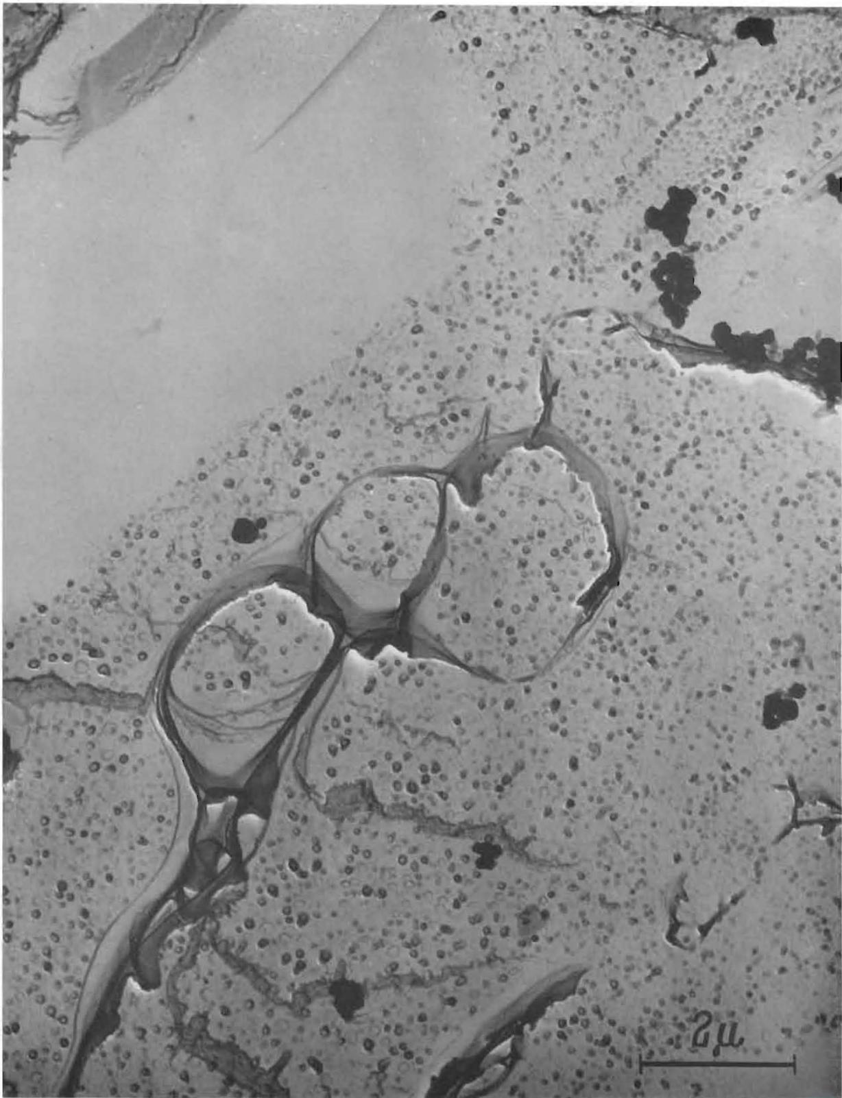
Bild 13: Elektronenmikroskopisches Bild der Bruchfläche eines einjährigen Pur-Zementsteins, W/Z = 0,4 (Kohlehüllen-Abdruck)
