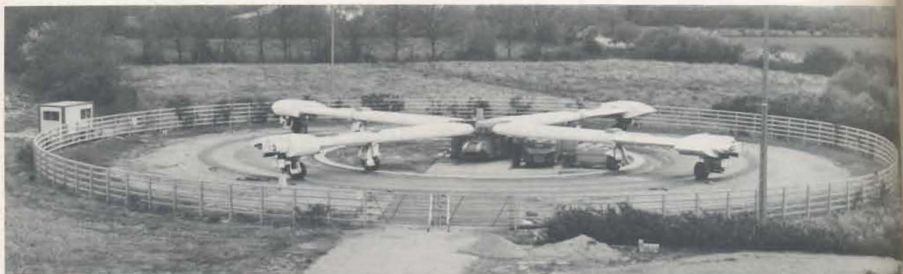
Fig. 1. — Le manège de fatigue du LCPC à Nantes.
