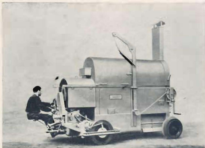
Abb. 2: Selbstfahrende Linnhoff-Motorkompressor-Spritzmaschine „Automain“ 900/1300 Ltr. Inhalt
