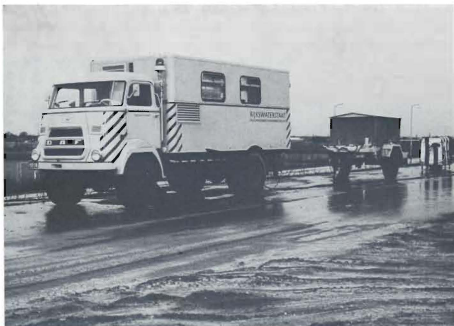
Fig. 39. Niet destructief onderzoek naar de elasticiteitsmoduli van verschillende lagen van de wegverharding door middel van trillingsmetingen.
