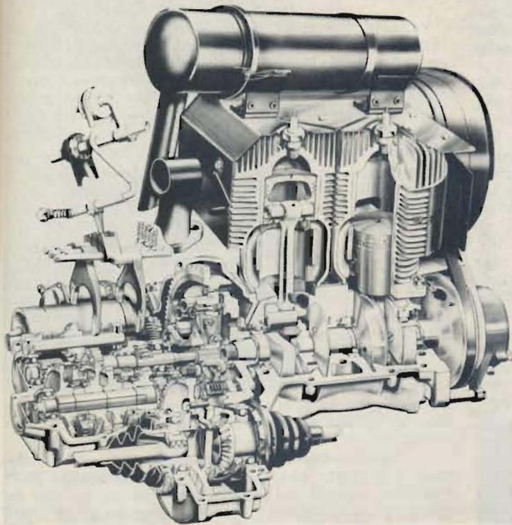
Bild 3. Schnitt durch den Motor des „Trabant 601“
