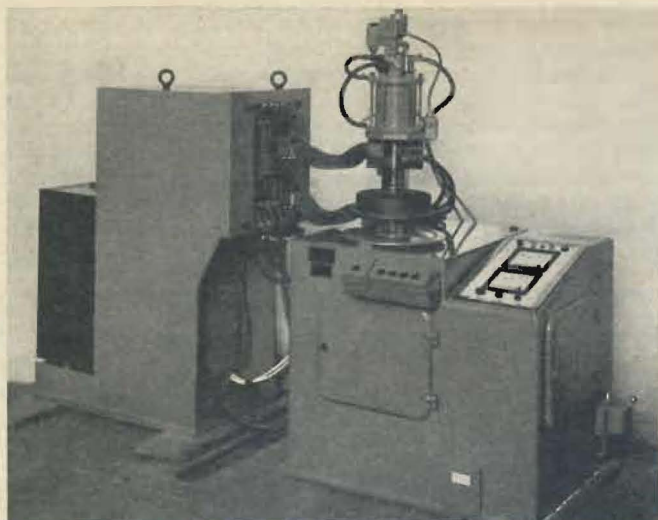
Bild 5. Elektronisch-dynamische Spezial-Auswuchtmaschine für das Auswuchten von Bremstrommeln mit Warzenschweißeinrichtung
