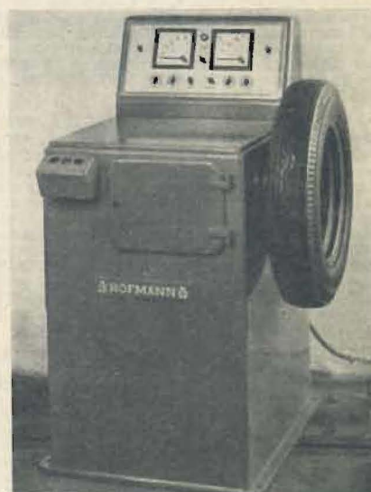
Bild 8. Elektronisch-dynamische Radauswuchtmaschine zum Auswuchten komplett montierter Autoräder in zwei Ebenen
