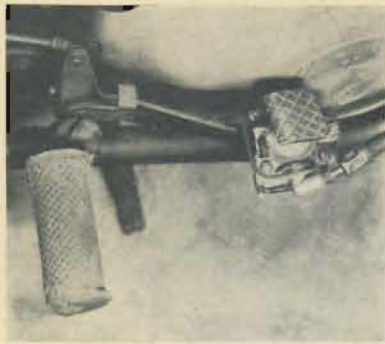
Bild 2. Hydraulischer Kraftmesser für Kraftrad-Fußbremsen. Wird am Fußbremshebel befestigt. Hersteller wie Bild 1
