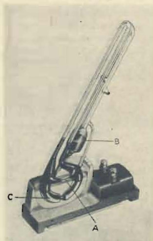
Bild 6. Flüssigkeitspendel des Siemens-Bremsmessers. A Ausgleichskapillare; B Temperatureausgleich; C Treibmasse
