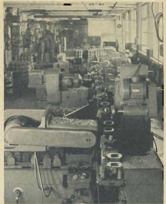
Bild 22. Fertigungsstraße aus Baueinheiten für die komplette Bearbeitung von Zylinderköpfen
