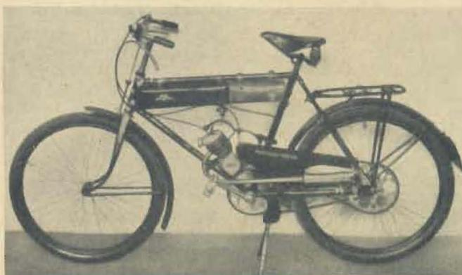
Bild 7. 40-cm<sup>3</sup>-Kratzsch-Motor im Fahrrad
