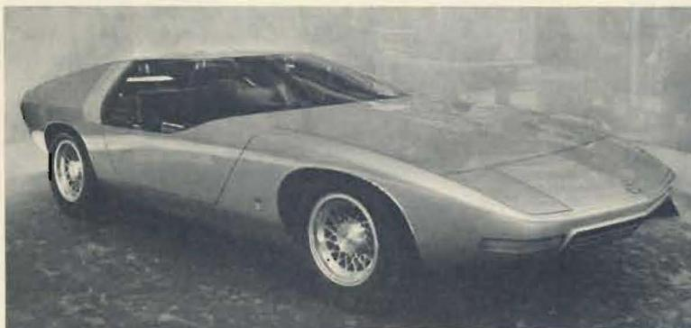
Bild 3. Der Experimentalwagen Opel CD ist aus dem Personenwagen Opel Diplomat abgeleitet. Zum Ein- und Aussteigen wird die ganze Mittelpartie mit Dach und pfostenloser Windschutzscheibe nach vorne/oben geschwenkt
