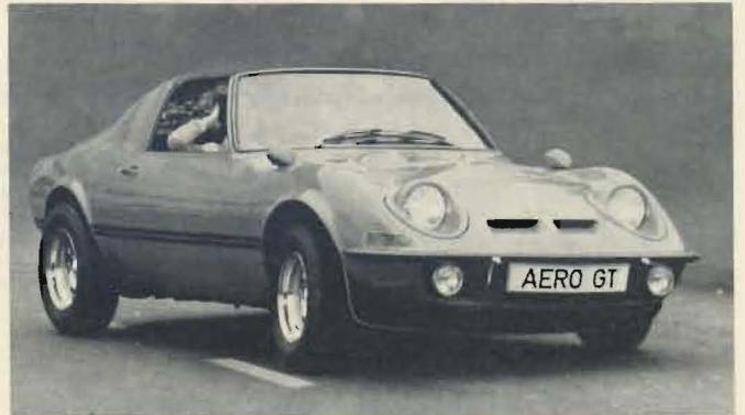
Bild 4. Prototyp Opel Aero GT, aus dem Modell GT abgeleitet, mit abnehmbarem Dach, Überrollbügel und versenkbarer Heckscheibe
