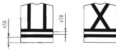
Bild A.5 — Beispiel eines Überwurfs
