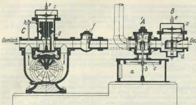
Abb. 2. Selas-Gas-Luft-Mischanlage; A Mischer, B Gasdruckregler, C Leistungregler; a Mischerunterteil, b Kolbenstange, c Membranbleche mit Lederauflage, c Membran, d Ventil, e Entlüftungsanschluß, f Rückschlagklappe, g Kolben, h Druckmeßstelle.
