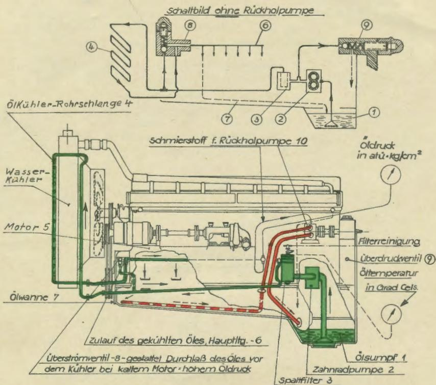
Abb. 2: Schmierstoffwege bei waagrechtliegendem Motor
