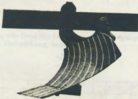
Abb. 52. Pflugkörper mit im Streichblech eingegrabenen Bahnen.
