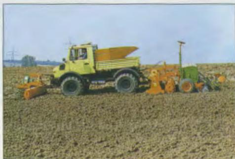
Abb. 13.1 c: Gerätekombinationen sparen Arbeitszeit, Kraftstoff und vermindern die Anzahl der Fahrspuren
