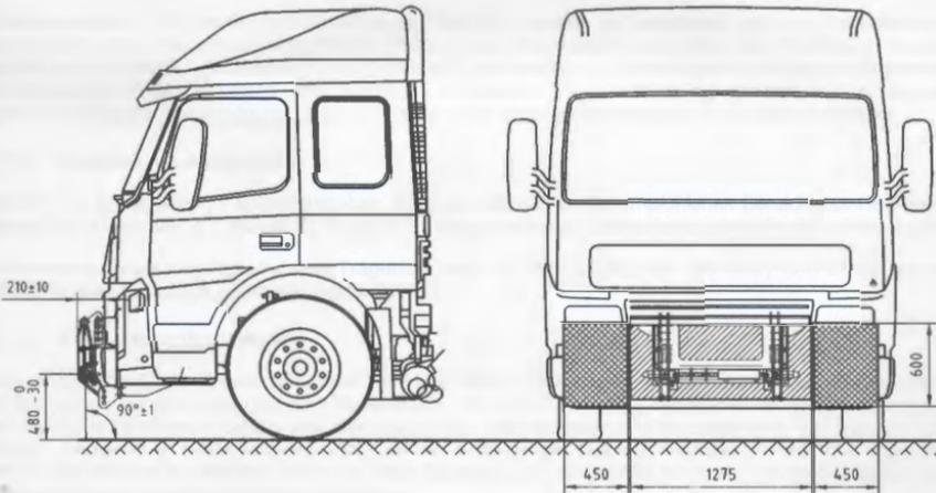
Bild A.2 — Gesamtansicht der Anbauplatte VV95 mit den Anbaupositionen für die Anschlüsse
