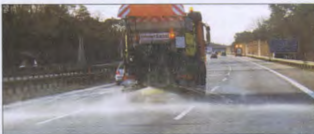
Bild 9: Küpper-Weisser – Kombinationsstreumaschine mit einer eingestellten Sprühdichte von 20 g/m 2 und einer Sprühbreite von 11,25 m
