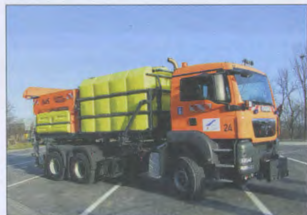
Bild 13: Kombinationsstreumaschine von Küpper-Weisser für 10.000 l Salzlösung und 5 cbm Trockensalz
