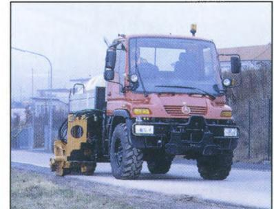
**Abb. A5.2** U 300 mit Asphaltfräse im Zwischenachs-anbau
