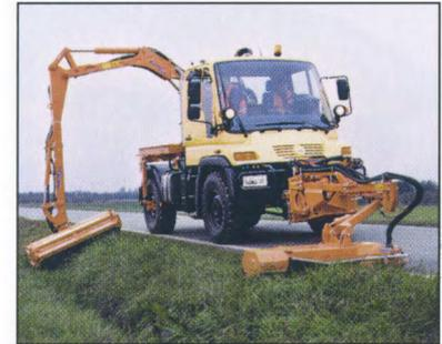
**Abb. A5.1** U 300 mit Randstreifen- und Auslegermähwerk
