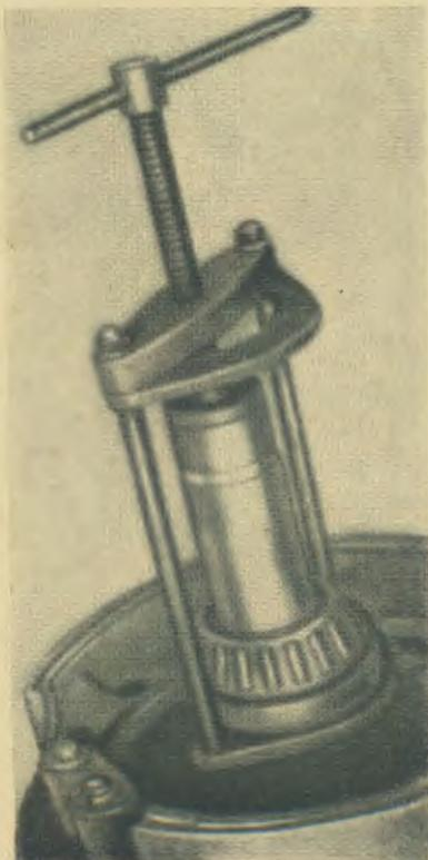
**Abb. 65 Abziehen des Dichtringes und des Innenringes des Kegellagers vom Achswellenrohr mit der Abziehvorrichtung 01**
