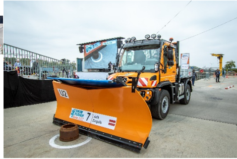
Bild 5 Verschieben einer Bremstrommel
